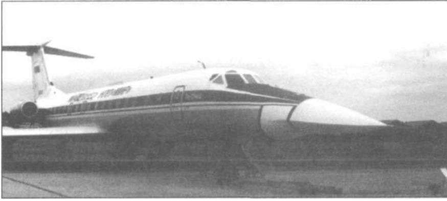
Летающая лаборатория на базе Ту-134 для испытаний аппаратуры «Морской змей» с носовой частью Су-32ФН.
