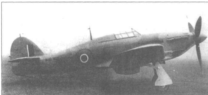
«Си Харрикейн» Mk I C с двигателем «Мерлин XX».
